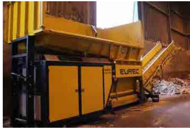
Abbildung: Zerkleinerer für Sperrabfälle in der Umschlagshalle
